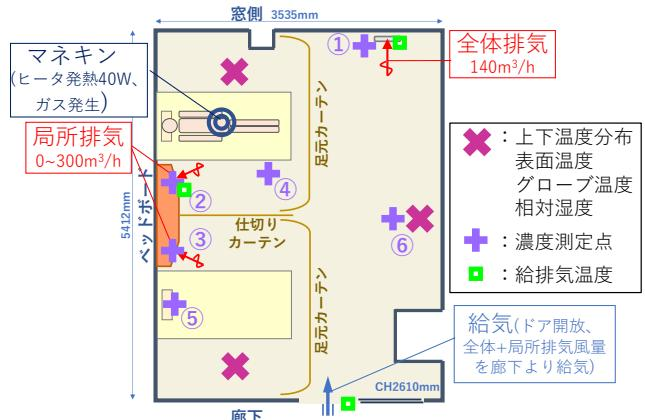
図1 モックアップ平面図と測定点
