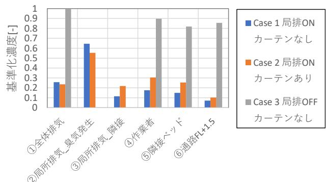
図 2 局排 ON/OFF とカーテン開閉の濃度分布への影響
