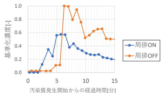
図 4 汚染質発生後の濃度変化の比較
